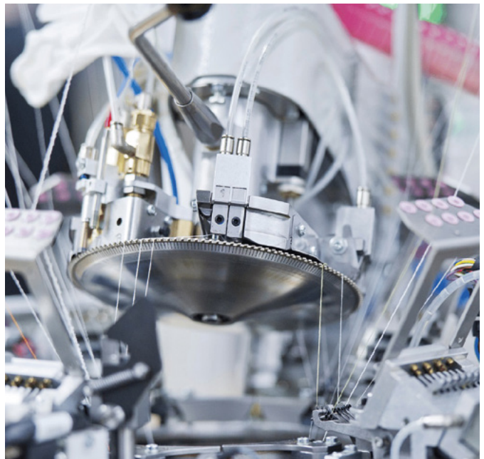
Mithilfe dieses Zylinders werden Rundstrick-versorgungen produziert.
